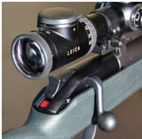
Una carabina dotata di pulsante disarmo del percussore. Un vistoso elemento rosso avvisa che il percussore è armato
