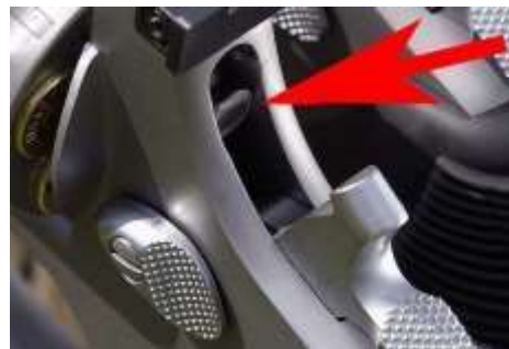
La sicura tipo “transfer bar” si interpone tra cane e percussore solamente quando si aziona il meccanismo di scaro
