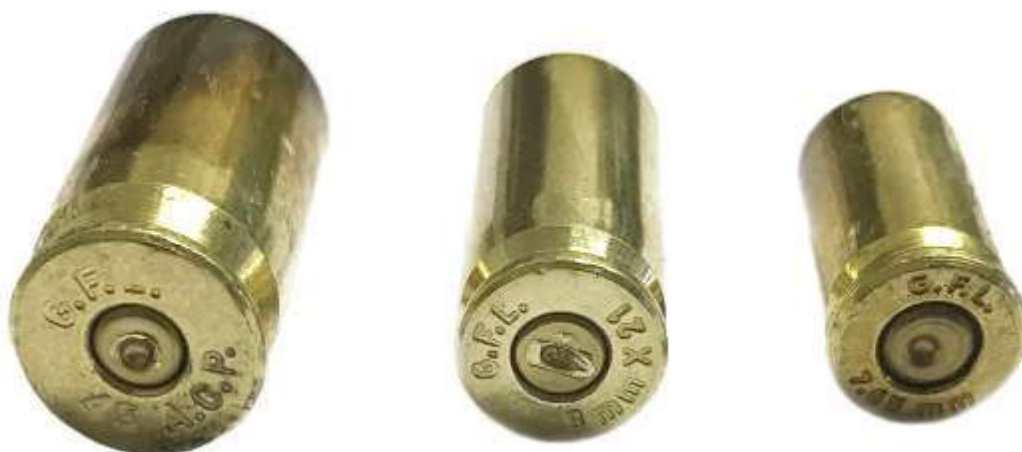
Foto di alcuni bossoli sparati che recano sulla capsula l'impronta del percussore. Si nota nel fondello l'indicazione del calibro e della fabbrica
