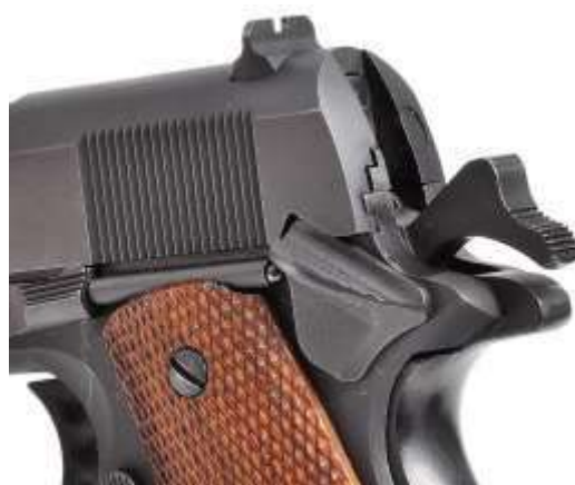
Una pistola Colt mod. 1911 con sicura inserita e cane armato. Il grilletto è bloccato, l'arma è "cocked and locked"
